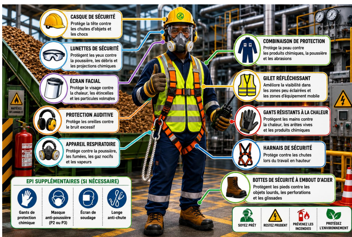
Figure 5.3 — EPI recommandés pour les techniciens de centrales biomasse
